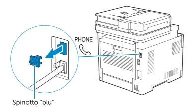
**3** Collegare il cavo di un telefono o di una segreteria telefonica al connettore telefonico sul retro della stampante. Collegare l'altra estremità del cavo al telefono esterno o alla segreteria telefonica esterna.
